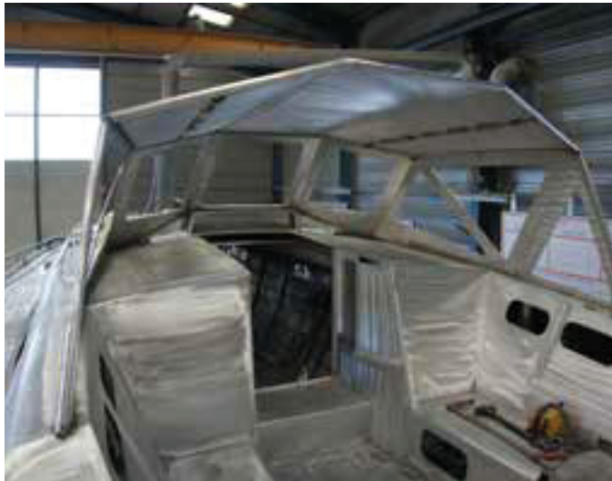
Schon beim Bau zeigt sich die Größe des schützenden Doghouses.
