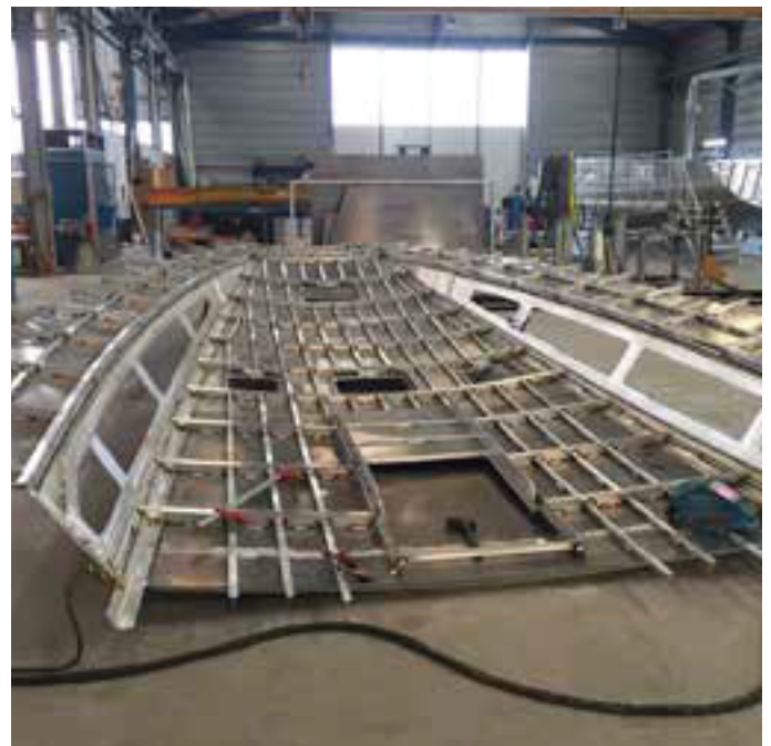
Eindrucksvoll - Das Decksegment vor seiner Montage auf den Rumpf.
