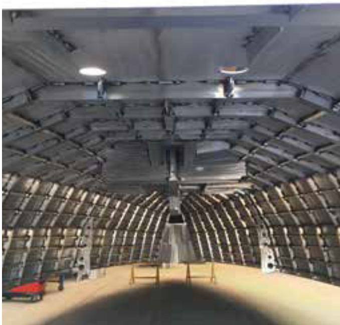
Ungewohnte Perspektive - Der Rumpf wird überkopf gebaut.
